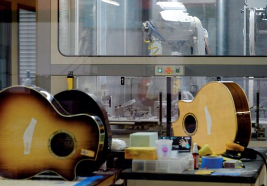
**L'application de la finition est robotisée et le séchage accéléré dans un four à UV**
