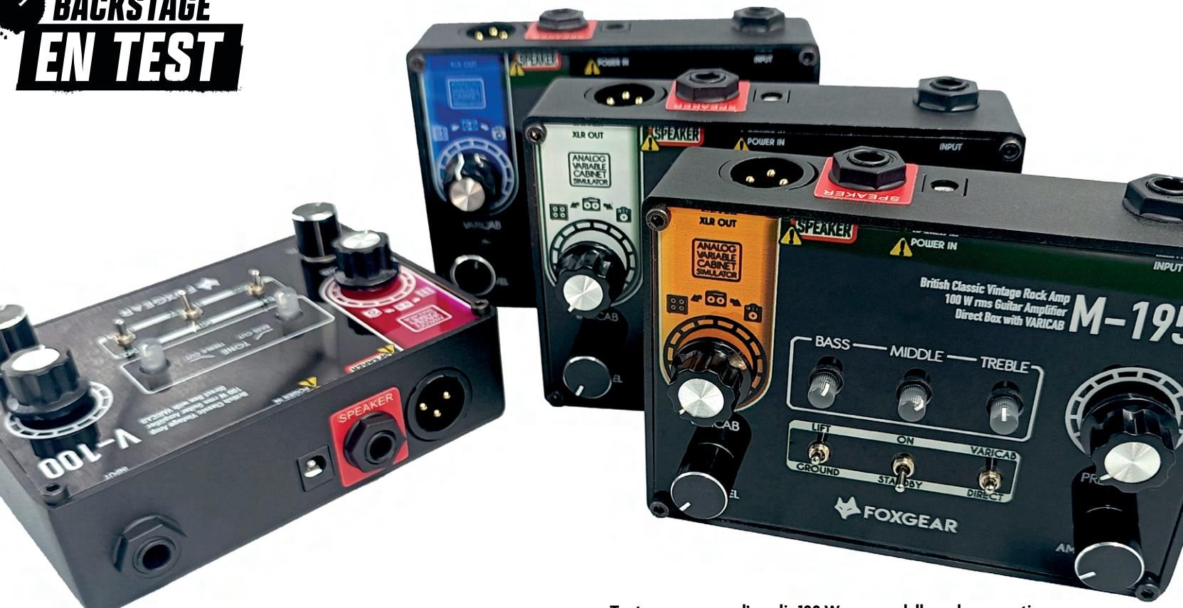
Toute une gamme d'amplis 100 W pour pedalboard avec sortie DI en XLR et émulations d'enceintes analogiques
